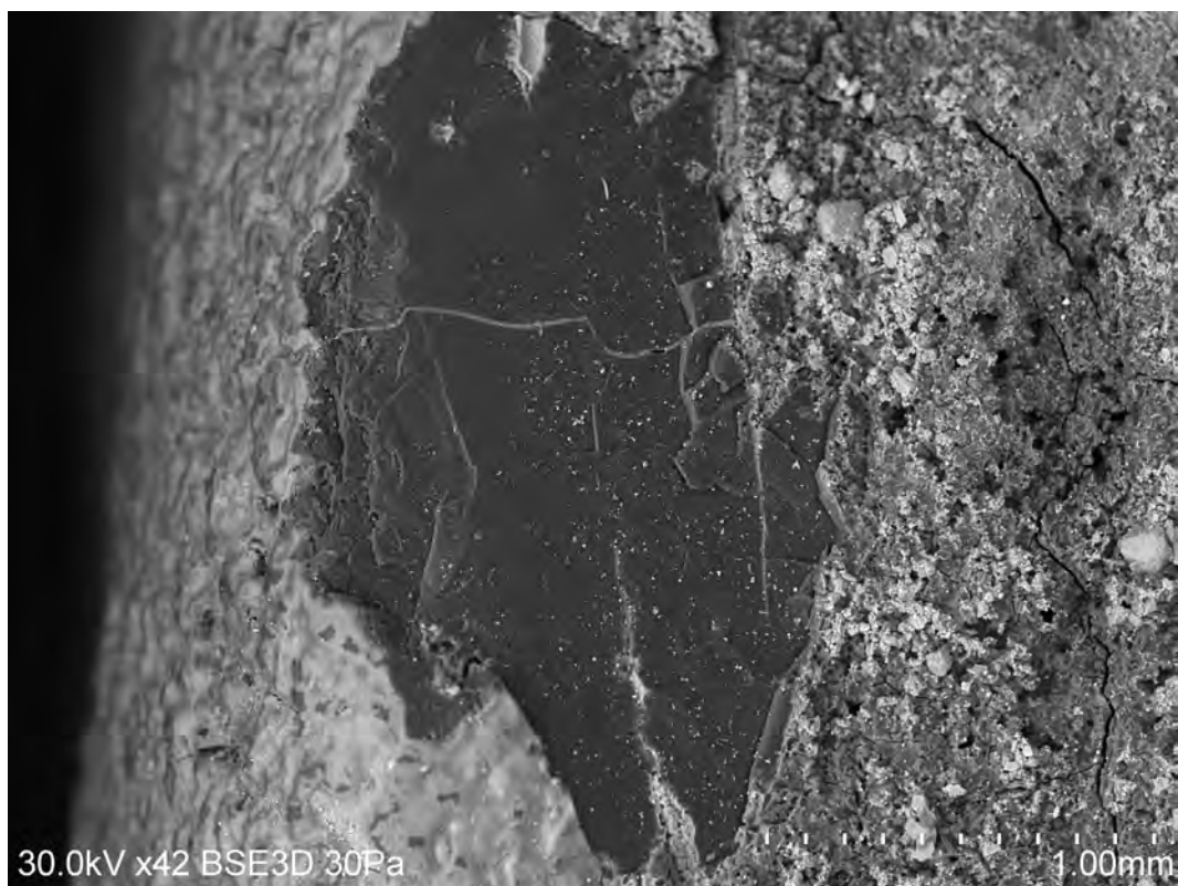
Ryc. 3. Obraz BSE powierzchni zabytku 2070p z widocznym ubytkiem w zdegradowanej warstwie odsłaniającym powierzchnię bursztynu (42×). Fot. W. Gil
